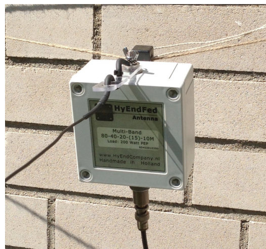
Positionierung vor der Hauswand, zwischen zwei Balkonen (optimale Stelle, geringstes SWR)
