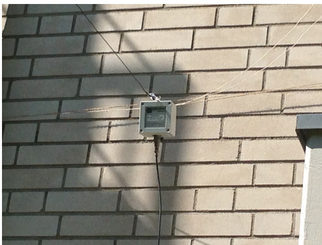
Positionierung vor der Hauswand, zwischen zwei Balkonen (optimale Stelle, geringstes SWR)
